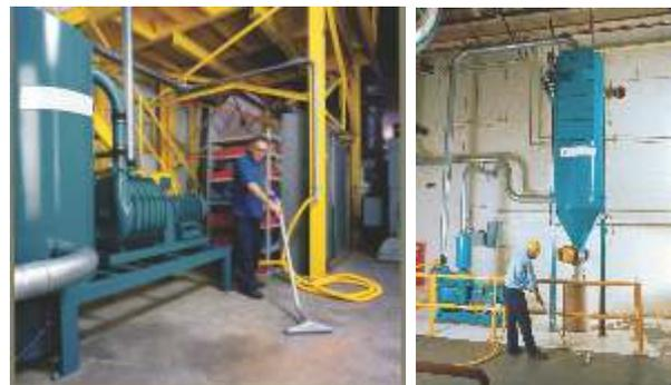
Sistema de Vácuo com Soprador Centrífugo para limpeza e captura de materiais contaminantes
