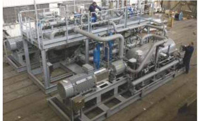
Sistema com Compressor para recuperação de gases.
